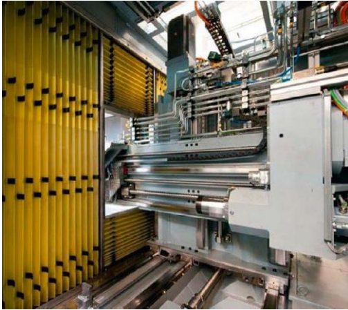
Abbildung 8 – KI-basierte Schutzabdeckungen für Werkzeugmaschinen (©Arno Arnold GmbH)
